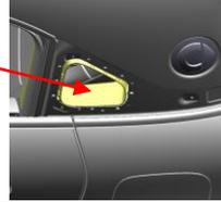
③ Abnehmbares Kabel durchtrennen; Anweisungen auf dem orangefarbenen Etikett befolgen.
