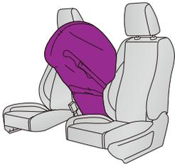
Además del airbag lateral, el asiento del conductor tiene un airbag central. La ubicación de este airbag central se muestra en la marca **9.** de la página 1.
