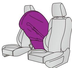
Le siège du conducteur a un airbag central en plus de l'airbag latéral. L'emplacement de l'airbag central est indiqué au repère 9. sur la page 1.
