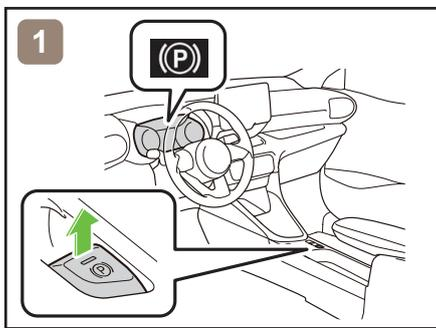
1. Blockieren Sie die Räder und ziehen Sie die Feststellbremse an.
