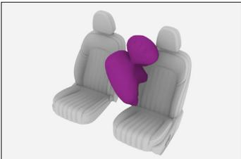
El asiento del conductor dispone de un airbag central además del airbag lateral. La ubicación del airbag central se muestra con la marca **9.** en la página 1.
