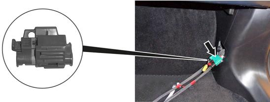
Le dispositif de coupure haute tension se trouve derrière le recouvrement, dans le montant A droit en bas.
