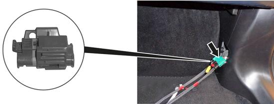
Die Hochvoltabschaltvorrichtung befindet sich unten in der A-Säule auf der Beifahrerseite.
