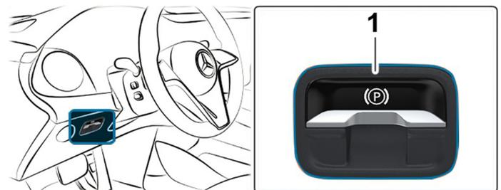
(1) Elektrische Feststellbremse
