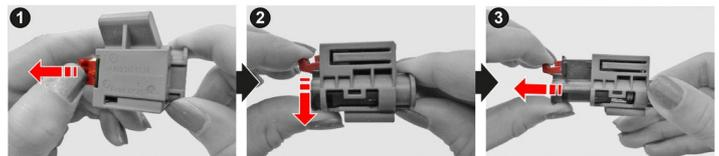
El dispositivo de desconexión del alto voltaje se encuentra en la parte inferior, en el montante A del lado del acompañante.
