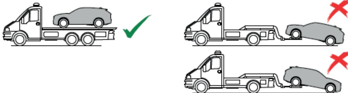
Wenn das Fahrzeug nicht mithilfe der empfohlenen Methode abgeschleppt werden kann, kann es im Notfall über eine kurze Distanz auf allen vier Rädern abgeschleppt werden. Das Fahrzeug nicht weiter als 50 km abschleppen. Nicht schneller als 50 km/h fahren.
