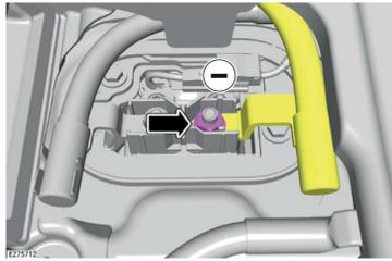
Die Masseklemmenmutter der Starterbatterie entfernen.
