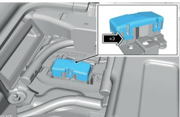
Die 3 Halteclips lösen.
