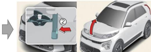
2. Motorhaube leicht anheben, Hebel in der Mitte der Motorhaube aus der halb eingerasteten Stellung (2) hochdrücken und Motorhaube anheben.
