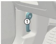
1. Entriegelungshebel (1) betätigen, um die Motorhaube zu entriegeln. Die Motorhaube sollte sich etwas öffnen.
