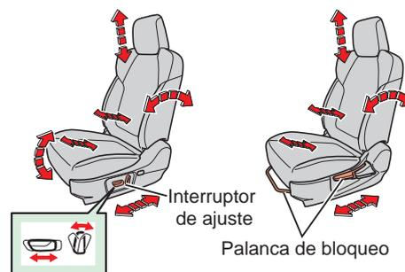
Es necesario el uso de la energía de la batería para accionar el asiento eléctrico.
