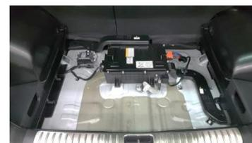
Il y a un conduit d'entrée / de sortie et le système de batterie 48V
