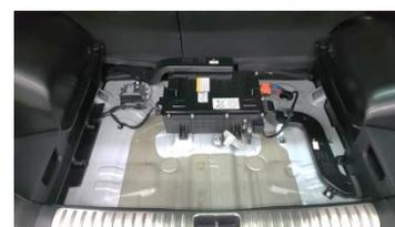
Encontrará los conductos de entrada y salida y el sistema de batería de 48V.
