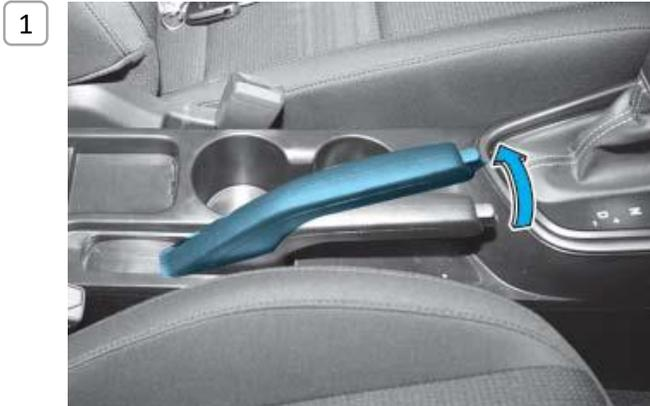
Handbremse so weit wie möglich anziehen
