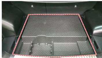
Entfernen Sie anschließend die Schaumstoffeinlage.
