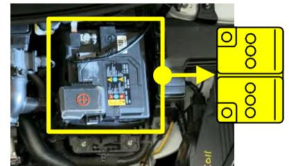
3. Batería de 12V en el compartimento del motor
