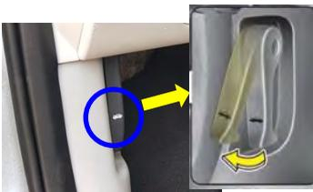
1. Tire de la palanca para abrir el capó. El capó debería saltar y abrirse ligeramente.
