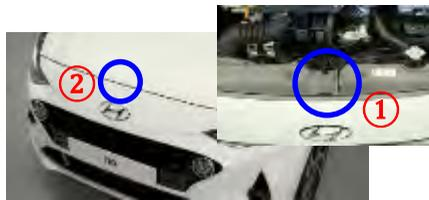
2. Eleve ligeramente el capó, tire del enganche (1) situado en el interior del centro del capó y levante el capó (2)
