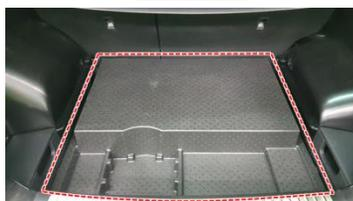
Après ouverture du couvre bagage, retirer le compartimenter en polystyrène.
