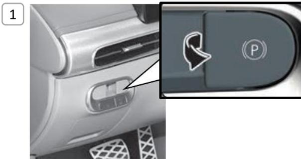
1. Calce las ruedas y tire del interruptor para accionar el freno de estacionamiento.
