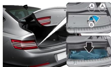
2. Para acceder a la batería, retire la hebilla (A) y suelte la tapa (B).
