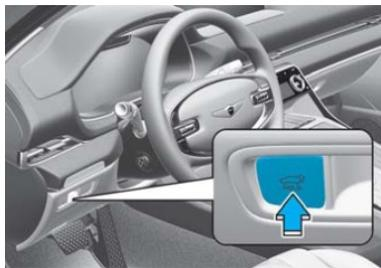
1. Heckklappenöffner (auf Armaturentafel) gedrückt halten, um elektrische Heckklappe zu öffnen.
