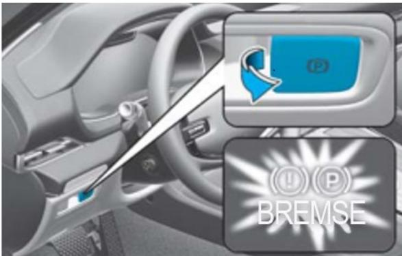
1. Zum Aktivieren der Feststellbremse Bremse betätigen und Schalter ziehen.
