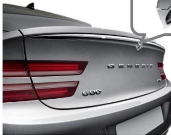
1. Mit Smartkey am Körper Heckklappenöffner (außen an der Heckklappe) drücken, um die elektrische Heckklappe zu öffnen.
