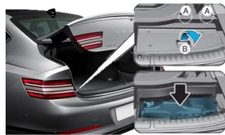
2. Um zur Batterie zu gelangen, die Sicherungsklammer (A) lösen und die Abdeckplatte (B) wegheben.
