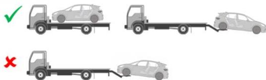
Ne pas remorquer un véhicule accidenté sur l'arbre de transmission.
