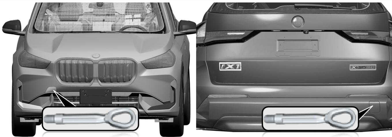
Utiliser uniquement l'anneau de remorquage fourni dans le véhicule et le visser jusqu'à la butée.
