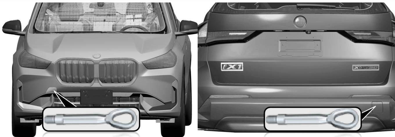
Nur die im Fahrzeug beiliegende Abschleppöse verwenden und diese bis zum Anschlag fest einschrauben.
