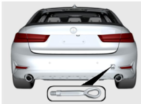
Nur die im Fahrzeug beiliegende Abschleppöse verwenden und diese bis zum Anschlag fest einschrauben.
