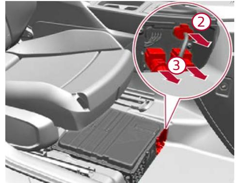
En caso de accidentes relacionados con la activación del airbag, la red de a bordo de 48 V se desactiva automáticamente.
